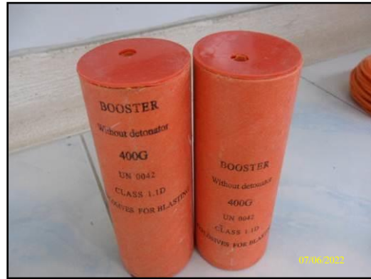
ภาพที่ 2.18 การใช้เก็บหน่วยงานเพื่อควบคุมปริมาณวัตถุระเบิดต่อจังหวัดการระเบิด ให้มีค่าน้อยกว่า 650 กิโลกรัม/จังหวัด
