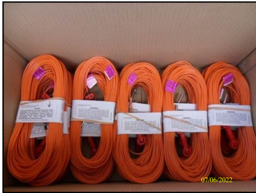
ภาพที่ 2.18 การใช้เก็บหน่วยงานเพื่อควบคุมปริมาณวัตถุระเบิดต่อจังหวัดการระเบิด ให้มีค่าน้อยกว่า 650 กิโลกรัม/จังหวัด
