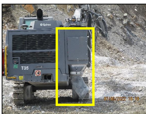
ภาพที่ 2.22 รถเจาะรูระเบิดที่ติดตั้งอุปกรณ์กำจัดฝุ่นที่ออกมาจากการเจาะรูระเบิด
