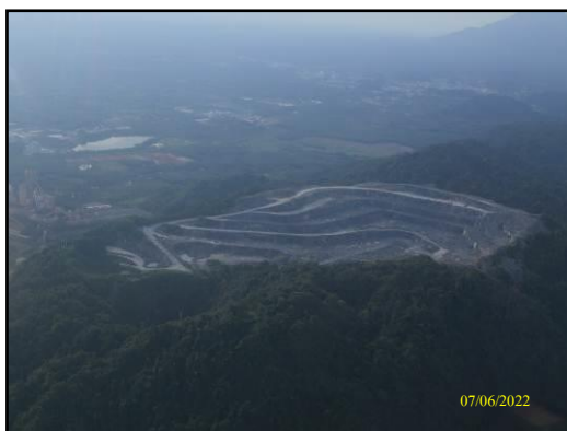
ภาพที่ 2.4 การเปิดหน้าเหมืองแบบ Semi Open Cut
