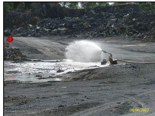
ภาพที่ 2.23 การฉีดน้ำดับฝุ่นขณะทำการระเบิด ด้วยหัวฉีด Twin Comet
