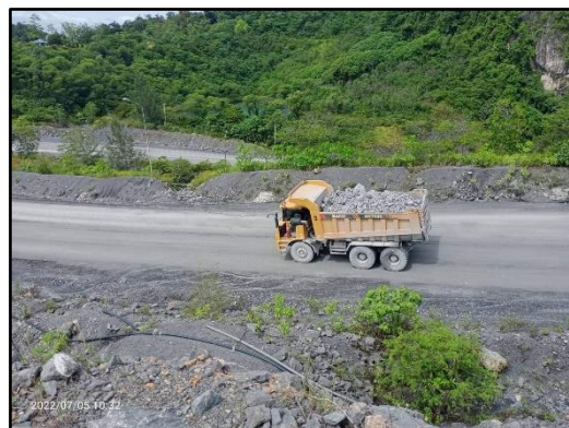
ภาพที่ 2.15 รถบรรทุกทุกเที่ยว ลำเลียงหินไปยังโรงบดย่อยหินปูน
